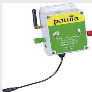
Das System GSM-Weidezaunalarm funktioniert über eine APP auf dem Smartphone und kann auch E-Mails versenden. Es braucht eine eigene Stromversorgung, die über einen eingebauten Akku bzw. ein mitgeliefertes Solarpanel sichergestellt wird. Das Gerät wird am entferntesten Punkt der Zaunanlage aufgestellt.
