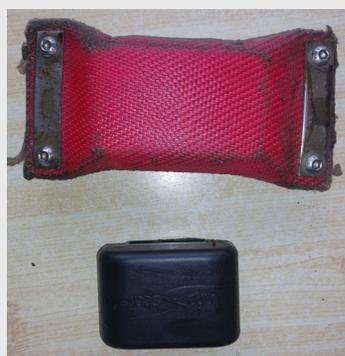
Aus diesem Foto ist der Größenvergleich zwischen GL 5B, welches ohne Hülle direkt auf den Riemen montiert werden kann, und Q-Track S1 und Infostar GL 501, für die eine Spezielle Schutzhülle benötigt wird, ersichtlich.
